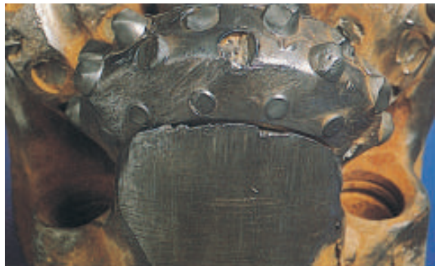
SHIRTTAIL DAMAGE (SD)
